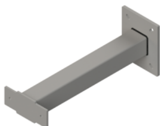
Art. ALPRD Prolunga da 200 mm fino a 850 mm per fissaggio a superficie d'installazione con ostacoli discontinui di sporgenza superiore a 300 mm.
