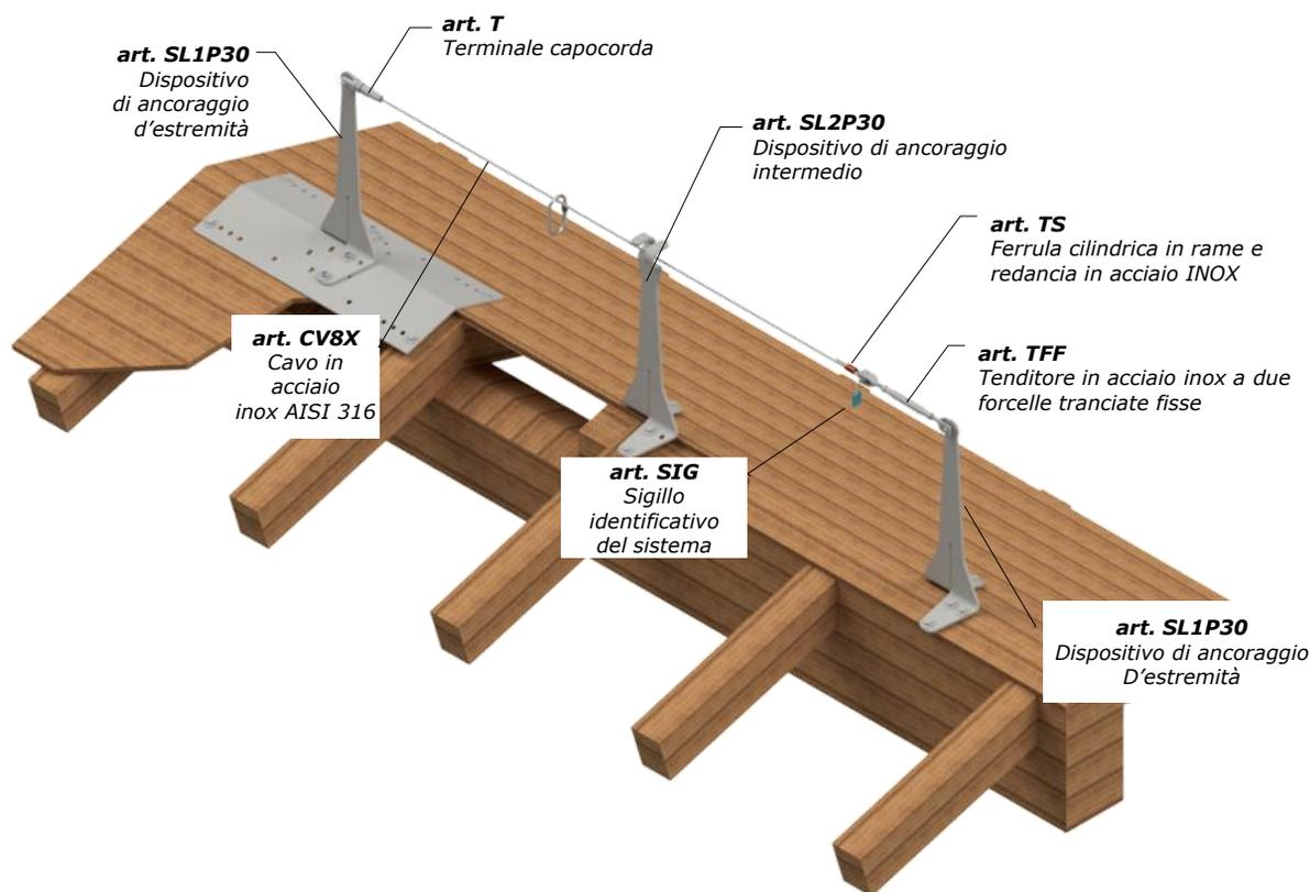
Kit per la realizzazione di linea d'ancoraggio flessibile composto da:
